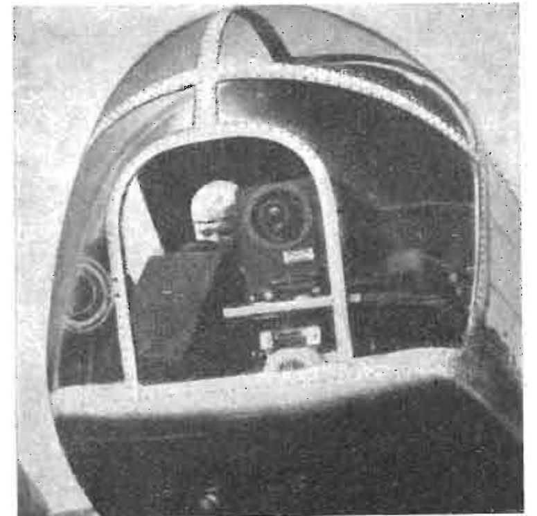
Camera da presa per televisione RCA installata su un aeroplano per la ricognizione aerea diretta. (Foto RCA).
